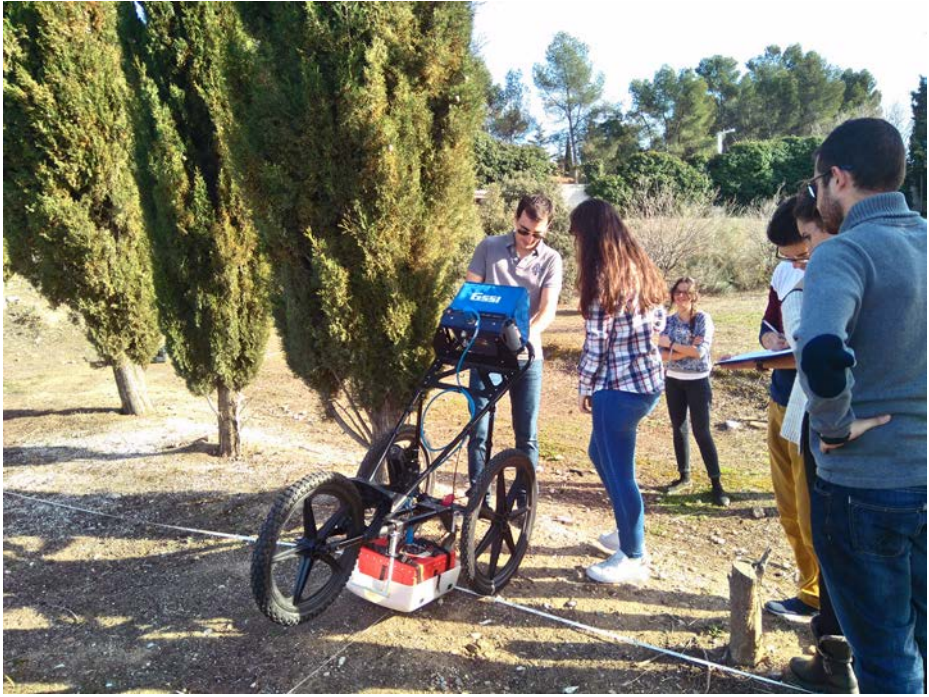
Fig. 3. (a) Práctica de georradar en el Alfar Romano. Se inyectan ondas electromagnéticas en el subsuelo y se reciben las reflexiones producidas en los distintos materiales. El modelo resultante es una imagen de los cuerpos reflectantes soterrados.
