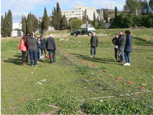
Fig. 4. Etapas de una actuación geofísica: (a) Adquisición de datos de tomografía eléctrica 2.5D en el Alfar Romano. Se inyecta corriente al subsuelo y se miden las diferencias de potencial.
